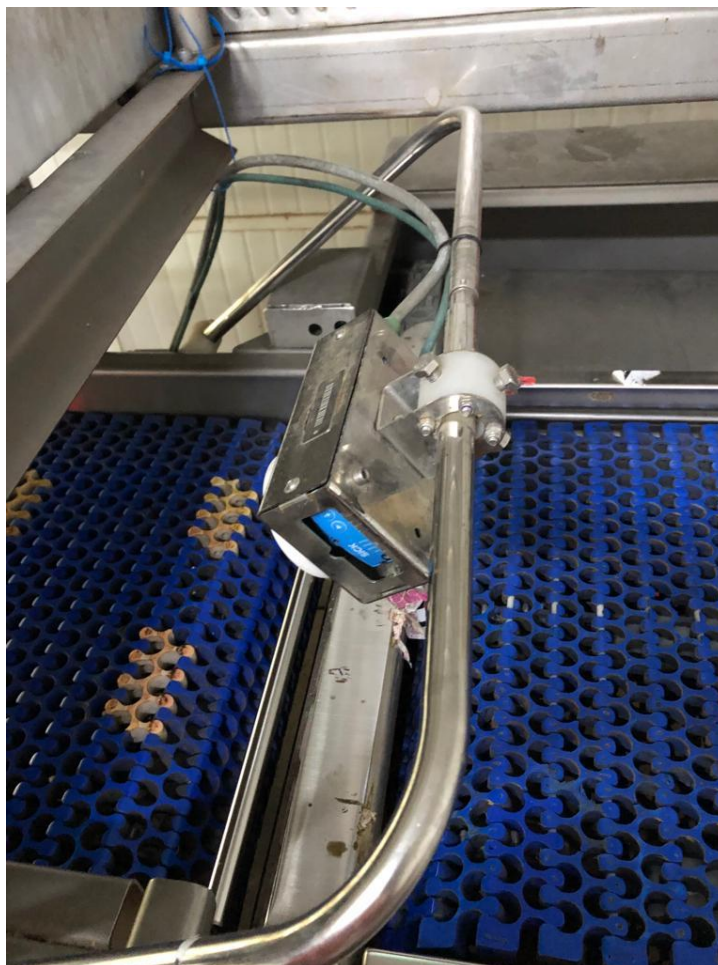
Figura 19: Instalação do leitor Bidimensional Fonte: O próprio autor.
