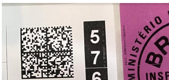
Figura 13: Etiqueta contendo o código de captura DataMatrix Fonte: o próprio autor.
