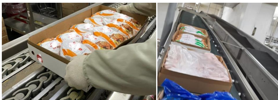
Figura 10: Funcionário realizando a atividade colocar as caixas na esteira condutora ao túnel de congelamento. Fonte: O próprio autor
