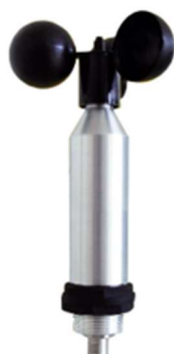
Figura 4 - Anemômetros de concha
