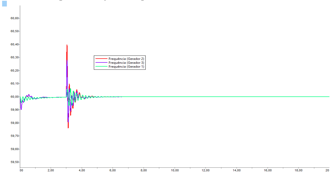
Figura 38 – Frequência dos geradores.
