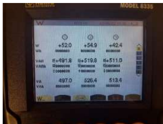
Figura 39- Potência do ensaio a vazio.
