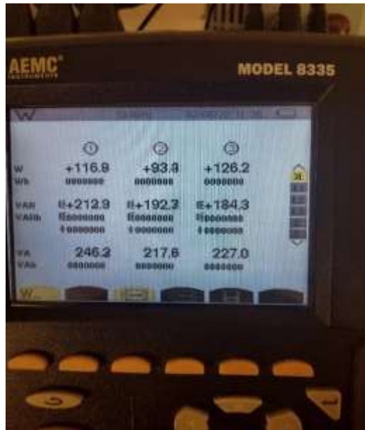
Figura 42- Potência Ativa do Ensaio de Rotor Bloqueado.
