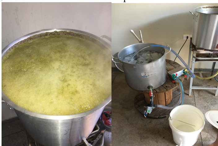
Figura 14 - Fervura do mosto com lúpulo e resfriamento do mosto
