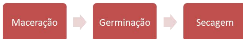
Figura 2 - Fluxograma do processo de maltagem
