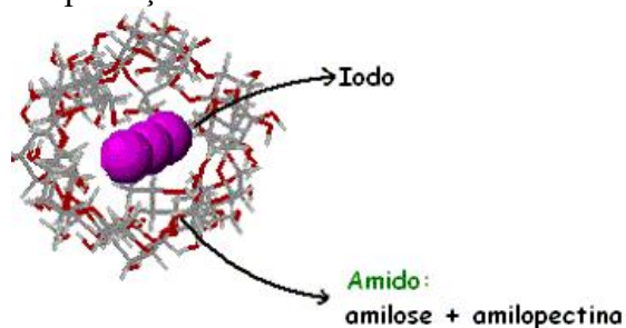
Figura 6 - Reação de complexação do iodo
