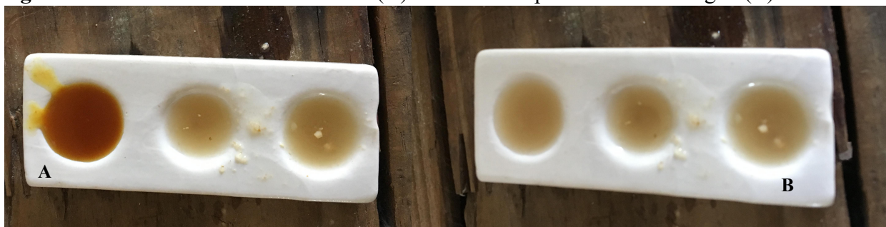
Figura 11 - Teste de iodo feito no início (A) e no final do processo de brassagem(B).
