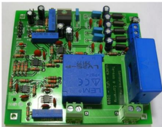
Figura 29: Módulo de aquisição de sinais
