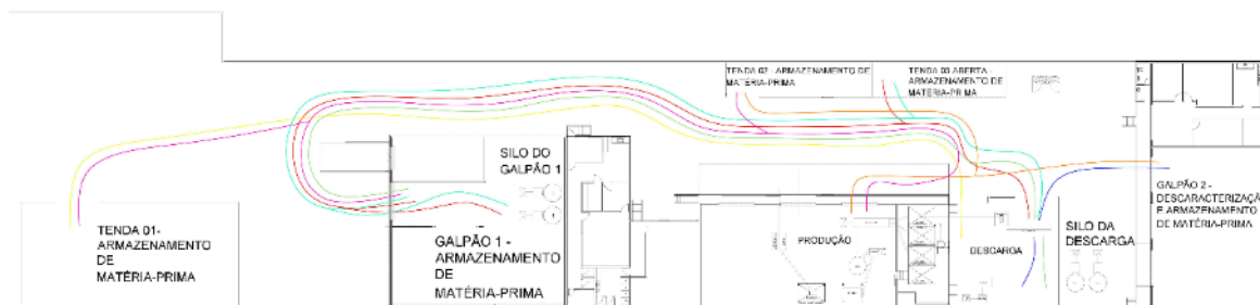
Figura 7 - Diagrama de Espaguete em cima das matérias-primas de categoria A da CURVA ABC da indústria X
