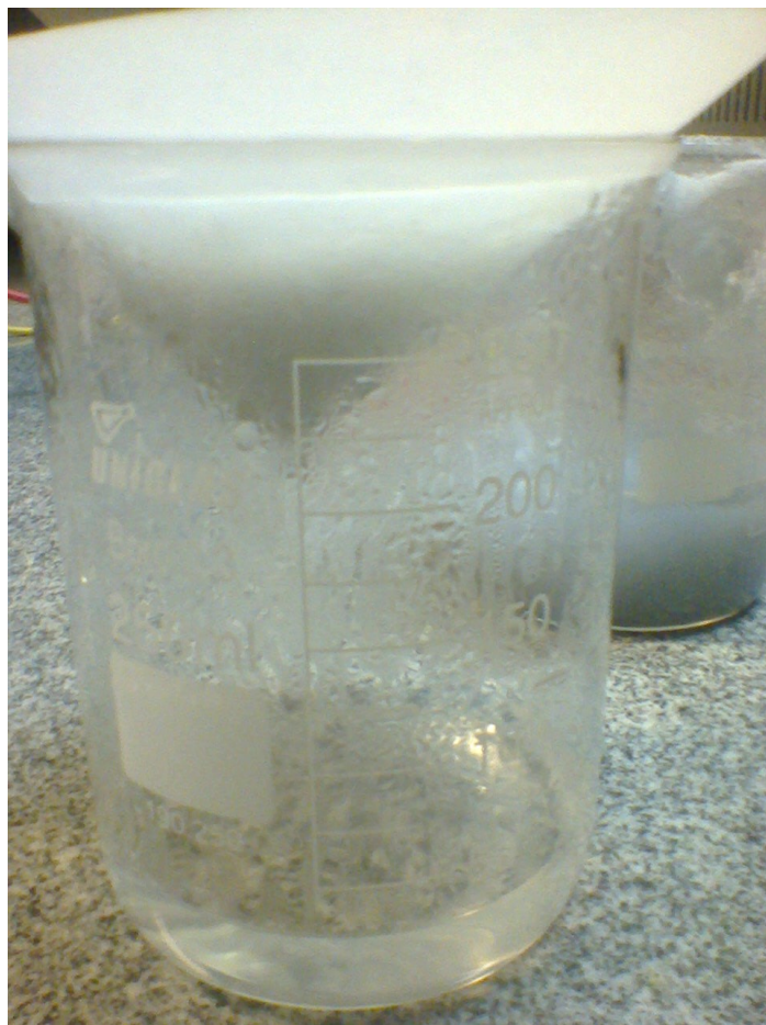
Figura 18: Filtração do efluente após o processo da eletrofloculação. (Fonte Própria).
