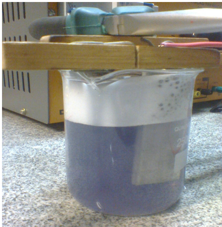
Figura 16: Experimento de eletrofloculação em laboratório. (Fonte Própria).
