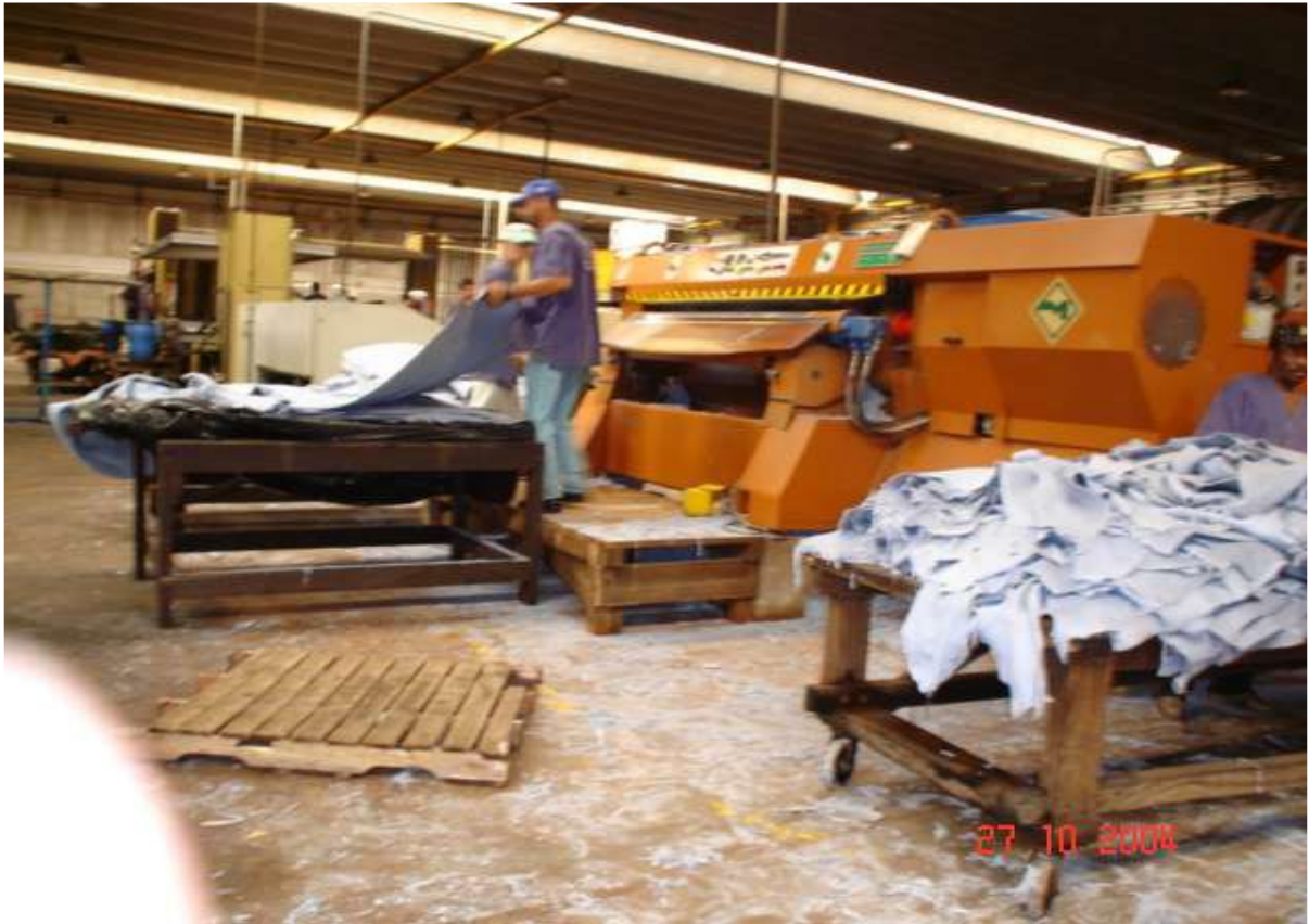
Figura 8: Máquina da seção de rebaixadeiras – rebaixamento dos couros recém-curtidos ao cromo (“wet-blue”), para ajuste de sua espessura (PACHECO, 2015).
