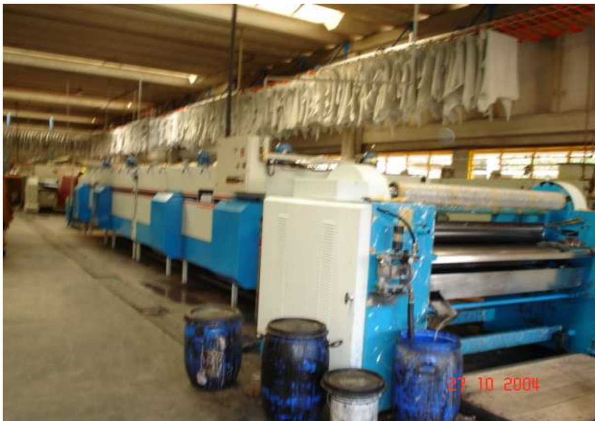
Figura 9: Máquina da seção de acabamento – aplicação de produtos químicos à superfície dos couros (PACHECO, 2015).
