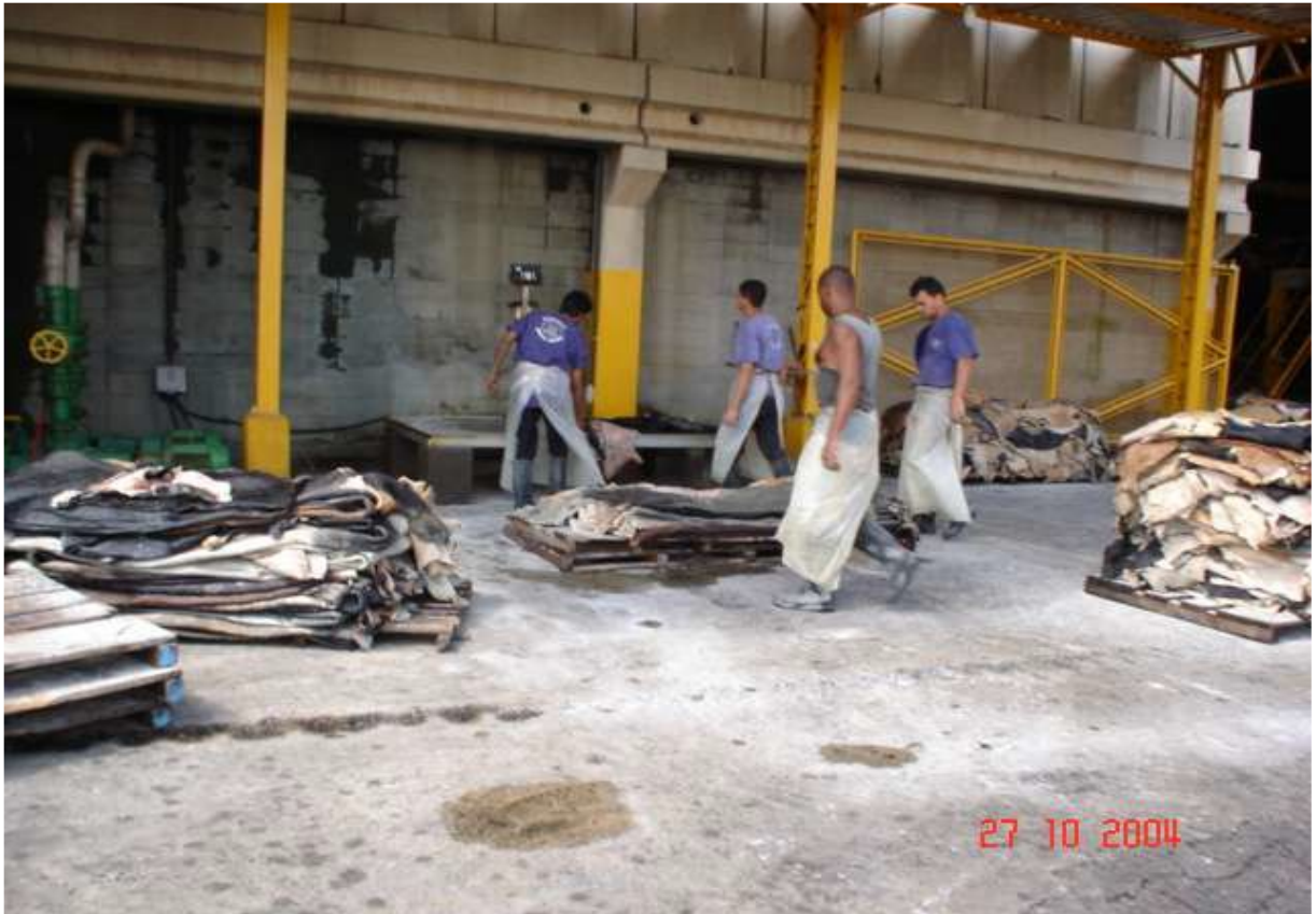
Figura 4: Separação, pesagem e montagem dos lotes de peles para início do seu processamento (pré-remolho ou remolho) (PACHECO, 2015).
