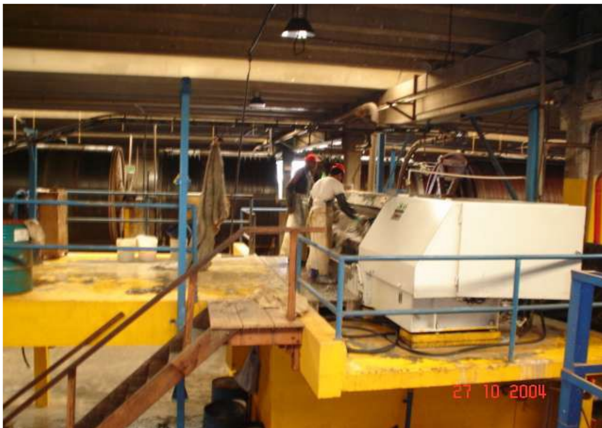
Figura 6: Máquina descarnadeira – remoção da carnaça aderida à superfície interior ou inferior das peles (PACHECO, 2015).
