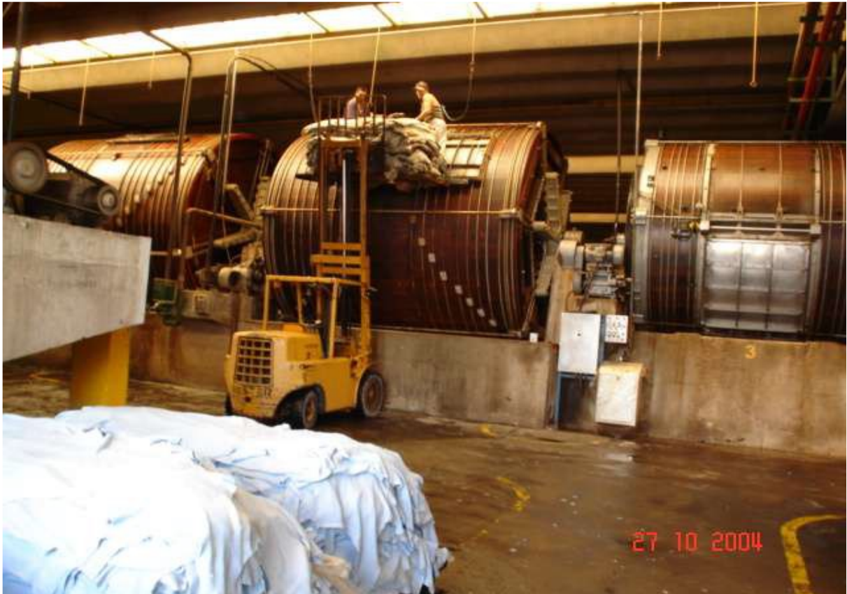
Figura 5: Grupo de fulões - operação de carga de peles para processamento (PACHECO, 2015).
