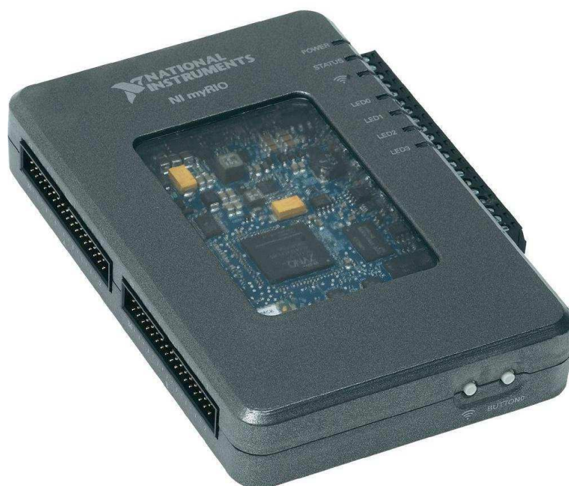
Figura 4.14 - Processador de tempo real NI MyRIO 1900 [18].
