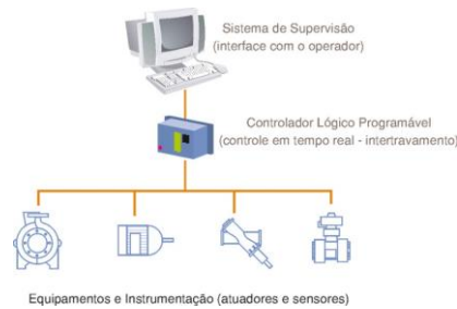
Figura 2.18 - Fluxo de comunicação em supervisórios [12].
