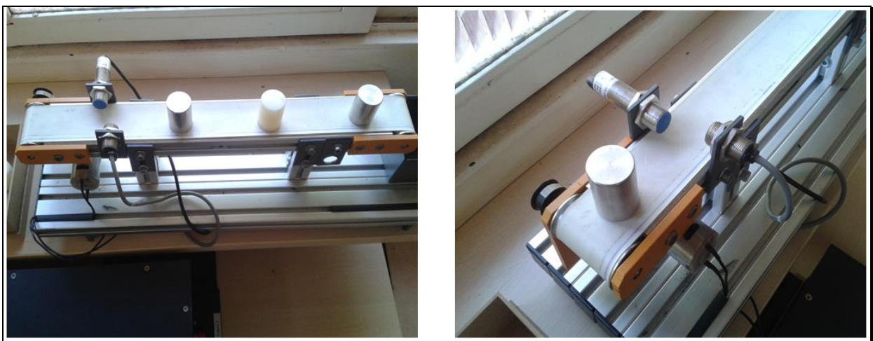
Figura 4.1 - Esteira de alimentação de peças.
