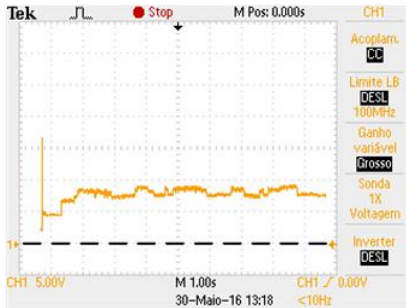
Figura 87 – Leitura do osciloscópio da tensão de entrada no C.Inc. a \alpha = 0,01 ( X = 1,00s/div , Y = 5V/div , tracejado situa o offset ).
