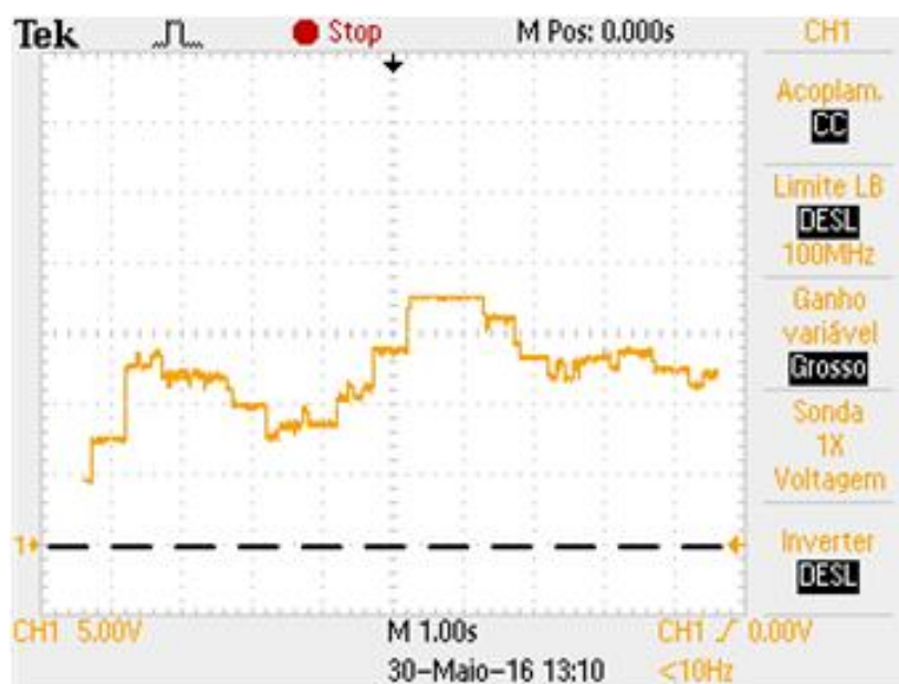
Figura 91 – Leitura II do osciloscópio da tensão de entrada no C.Inc. a \alpha = 0,04 ( X = 1,00s/div , Y = 5V/div , tracejado situa o offset ).
