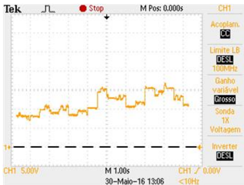
Figura 92 – Leitura I do osciloscópio da tensão de entrada no C.Inc. a \alpha = 0,08 ( X = 1,00s/div , Y = 5V/div , tracejado situa o offset ).
