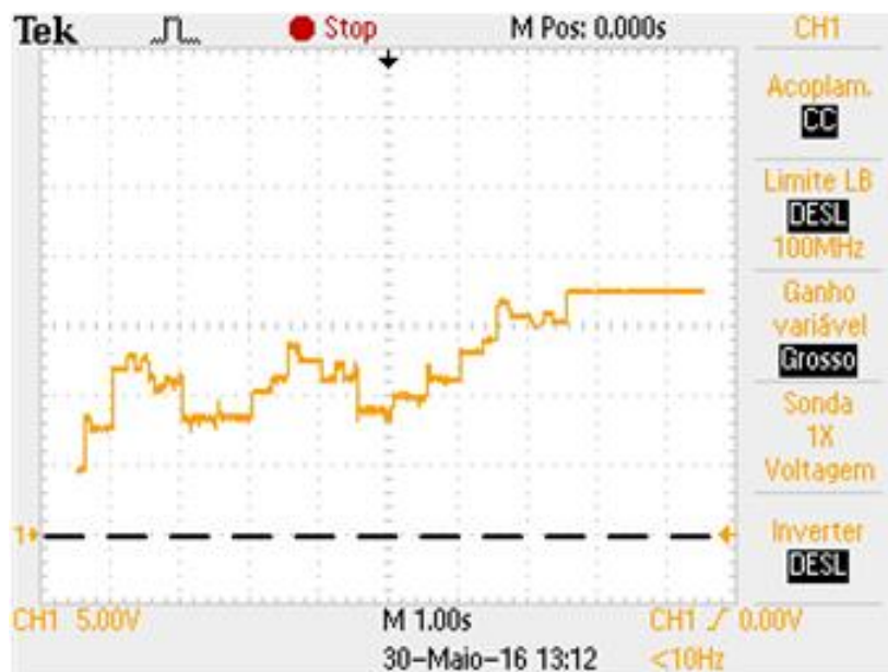
Figura 90 – Leitura I do osciloscópio da tensão de entrada no C.Inc. a \alpha = 0,04 ( X = 1,00s/div , Y = 5V/div , tracejado situa o offset ).
