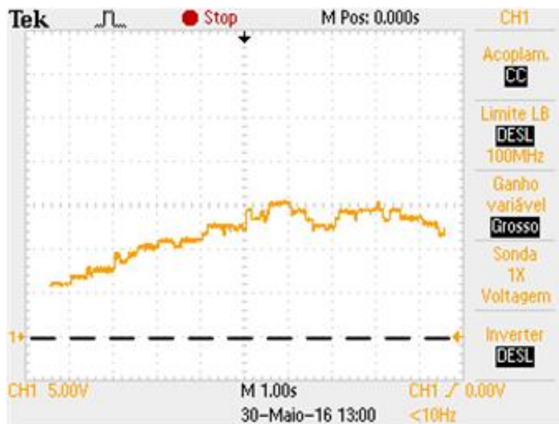
Figura 61 – Leitura do osciloscópio da tensão de entrada a dV = 0,8 V ( X = 1,00s/div , Y = 5V/div , tracejado situa o offset ).
