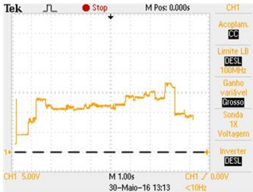
Figura 89 – Leitura II do osciloscópio da tensão de entrada no C.Inc. a \alpha = 0,025 ( X = 1,00s/div , Y = 5V/div , tracejado situa o offset ).
