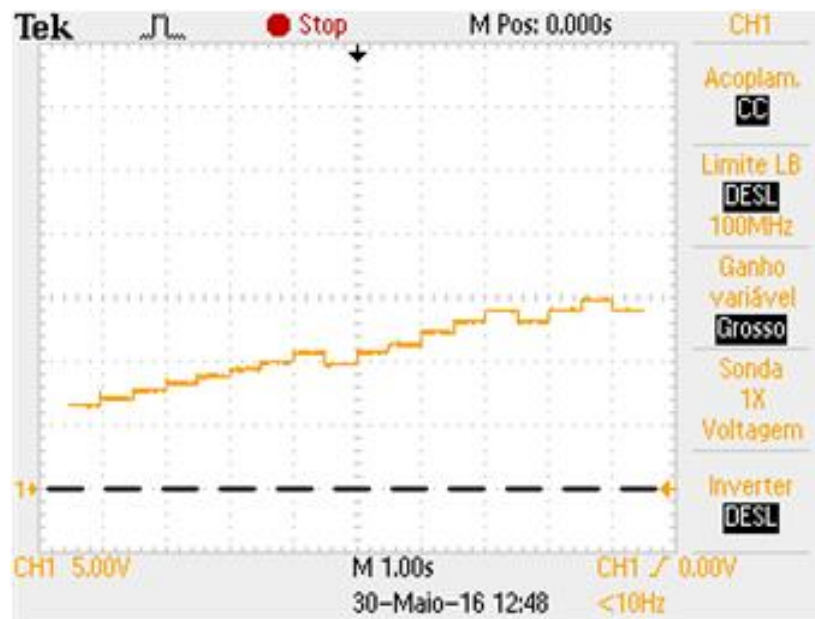
Figura 68 – Leitura do osciloscópio da tensão de entrada a \delta = 3\% ( X = 1,00s/div , Y = 5V/div , tracejado situa o offset ).
