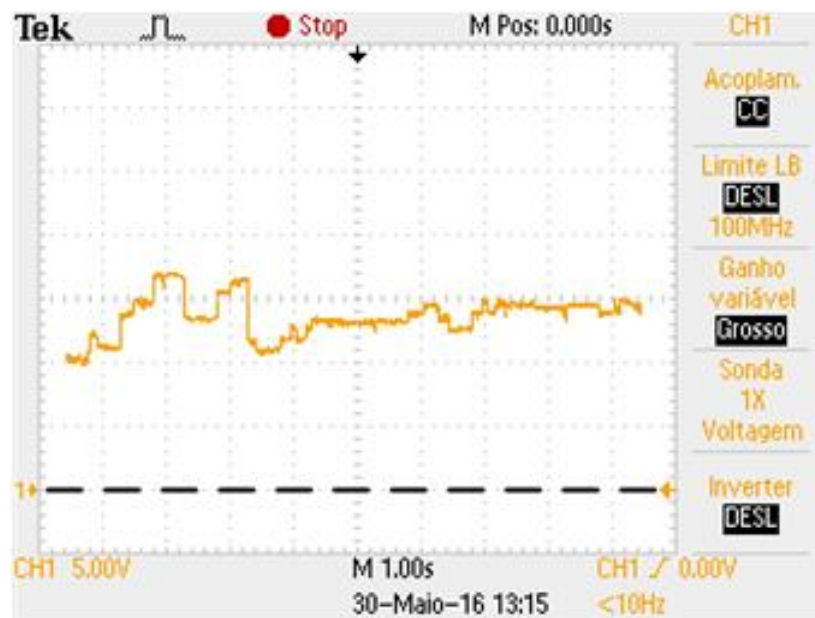
Figura 88 – Leitura I do osciloscópio da tensão de entrada no C.Inc. a \alpha = 0,025 ( X = 1,00s/div , Y = 5V/div , tracejado situa o offset ).
