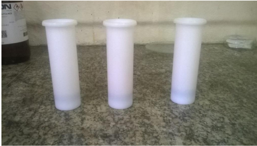
Figura 3 Frascos contendo a amostra solubilizada com \text{HNO}_3
