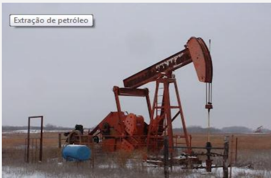
Figura 8: “Cavalo de pau” para extração de petróleo.
