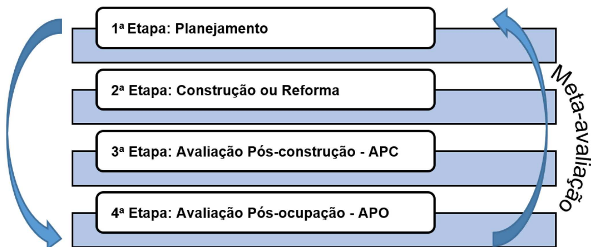
Figura 6 - Etapas da construção/reforma de edifícios de campus
