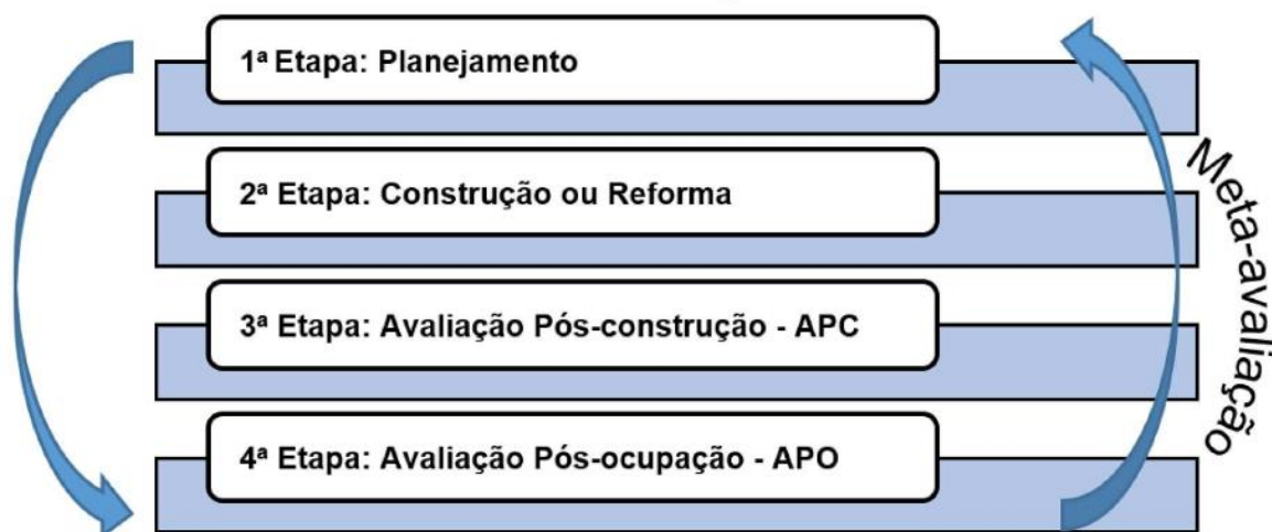
Figura 6 - Etapas da construção/reforma de edifícios de campus
