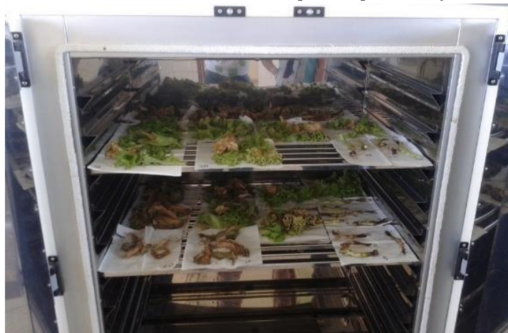
Figura 5 - Estufa com as amostras frescas prontas para começar a secagem.
