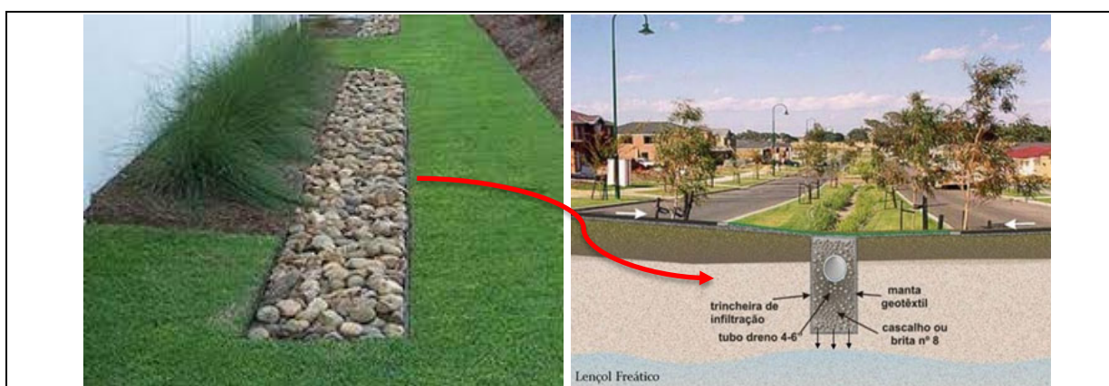
Figura 16 – Trincheira de infiltração em passeio gramado
