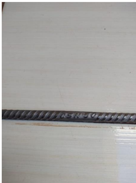
Figura 3.1 - Barra CSN com marca e categoria do material em alto relevo
