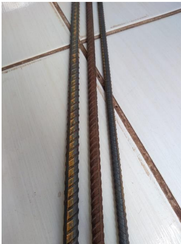
Figura 3.3 - Marcas de oxidação em barras Gerdau
