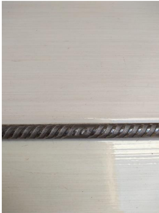
Figura 3.2 - Barra CSN com diâmetro nominal de 10mm exposto em alto relevo
