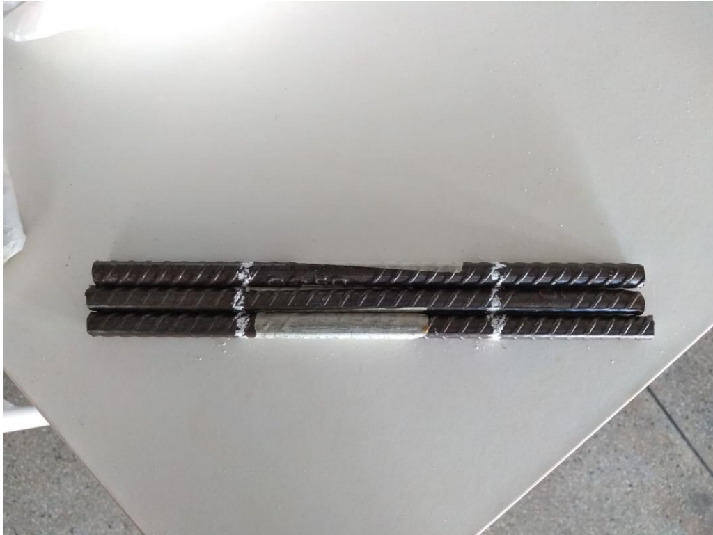
Figura 3.12 - Barras Gerdau 12,5mm com marcação de giz
