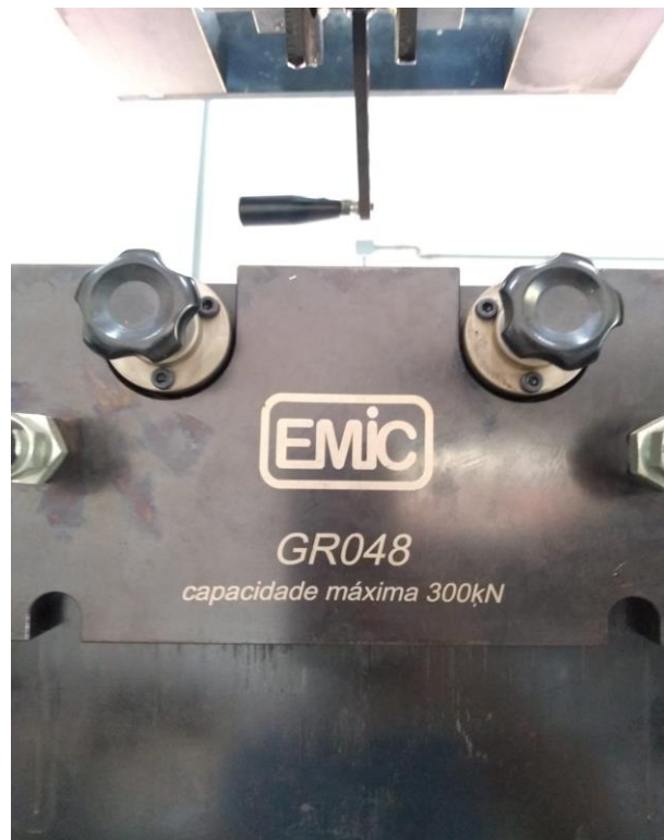
Figura 3.10 - Especificações da prensa de tração
