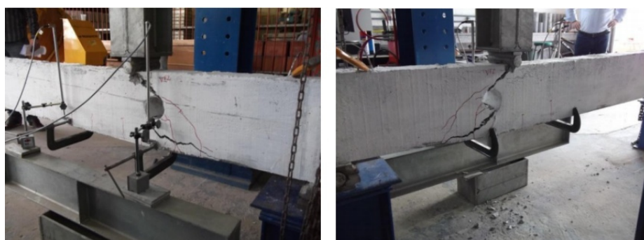
Figura 13 – Forma de ruptura de vigas de concreto armado sem reforço em abertura
