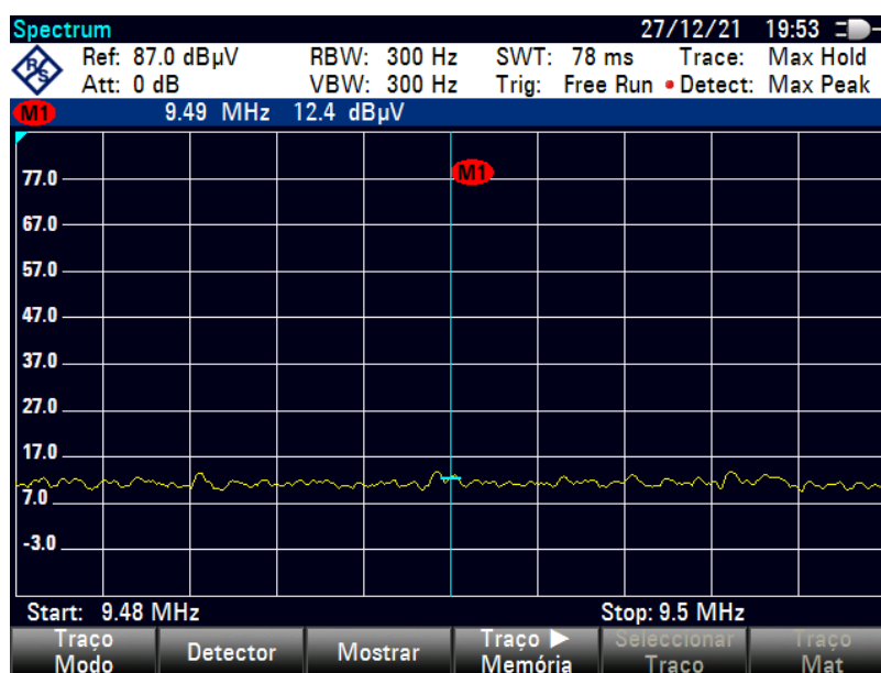
Figura 3.8 - Teste 4 - Espectro do sinal do DRM, na faixa de frequência 9,48-9,5 MHz, frequência de centro 9,49 MHz, sem a presença do PLC (Próprio Autor, 2021).
