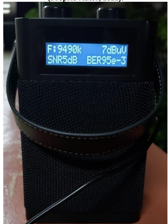
Figura 3.10 - Teste 6 - DRM sintonizado na faixa de frequência 9,49 MHz, com a presença do PLC (Próprio Autor, 2021).
