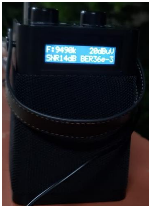
Figura 3.11 - Teste 7 - DRM sintonizado na faixa de frequência 9,49 MHz, sem a presença do PLC (Próprio Autor, 2021).
