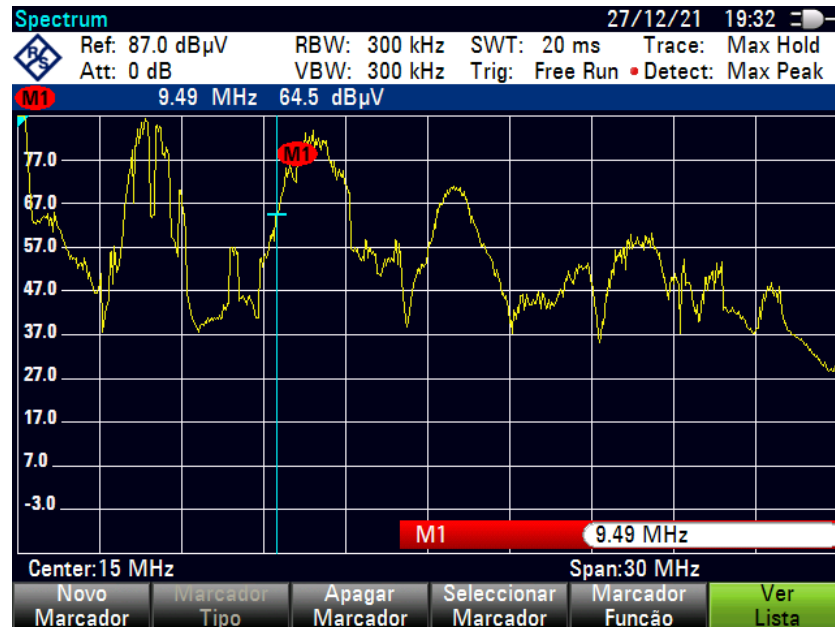
Figura 3.6 - Teste 2 – Espectro do sinal do DRM, na faixa de frequência 0-30 MHz, frequência de centro 9,49 MHz, com a presença do PLC (Próprio Autor, 2021).
