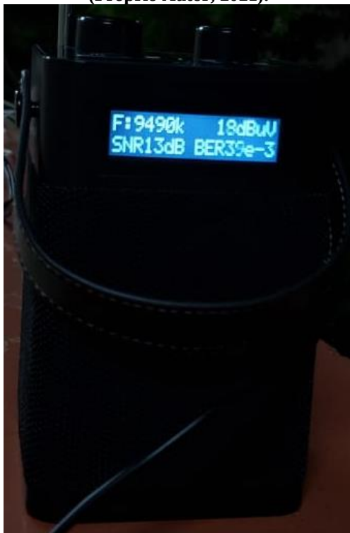
Figura 3.9 - Teste 5 - DRM sintonizado na faixa de frequência 9,49 MHz, sem a presença do PLC (Próprio Autor, 2021).
