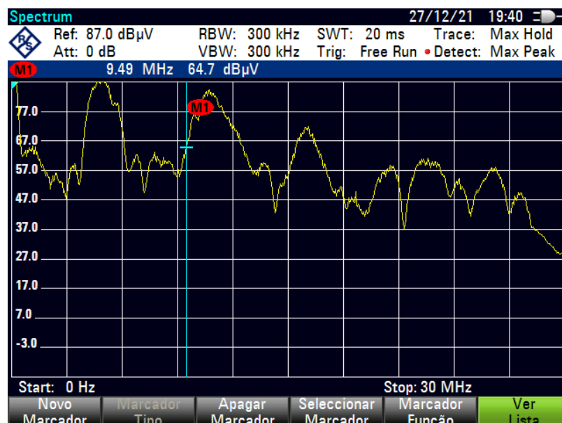
Figura 3.7 - Teste 3 - Espectro do sinal do DRM, na faixa de frequência 0-30 MHz, frequência de centro 15 MHz, com a presença do PLC (Próprio Autor, 2021).
