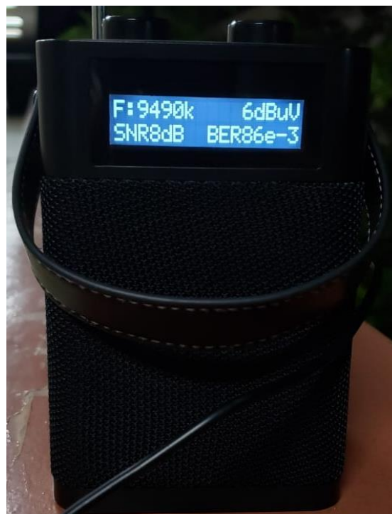
Figura 3.12 - Teste 8 - DRM sintonizado na faixa de frequência 9,49 MHz, com a presença do PLC (Próprio Autor, 2021).
