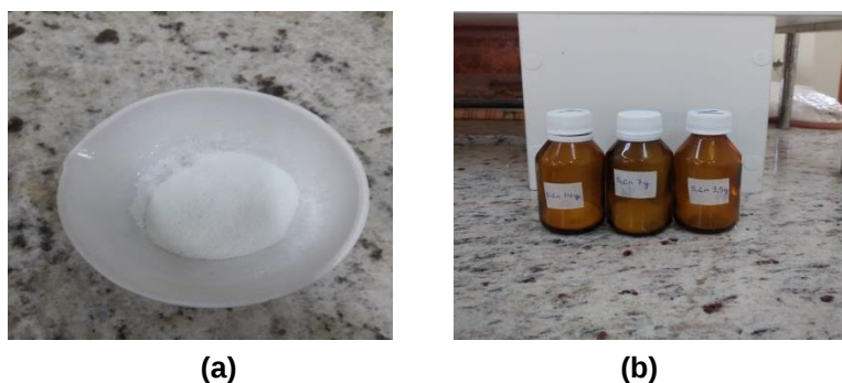
Figura 9- Fotografias: Amostra SiZn2 após calcinação e maceração do pó (a); Armazenamento dos fotocatalisadores SiZn1, SiZn2 e SiZn3 (b).
