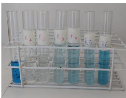
Figura 21- Fotografia: Suspensões do corante com fotocatalisador SiZn2 usado em seis reciclagens.
