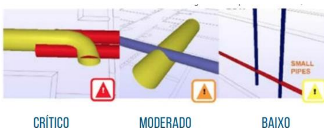
Figura 6 – Localização e classificação automática de interferências geométricas, geradas por um software BIM.
