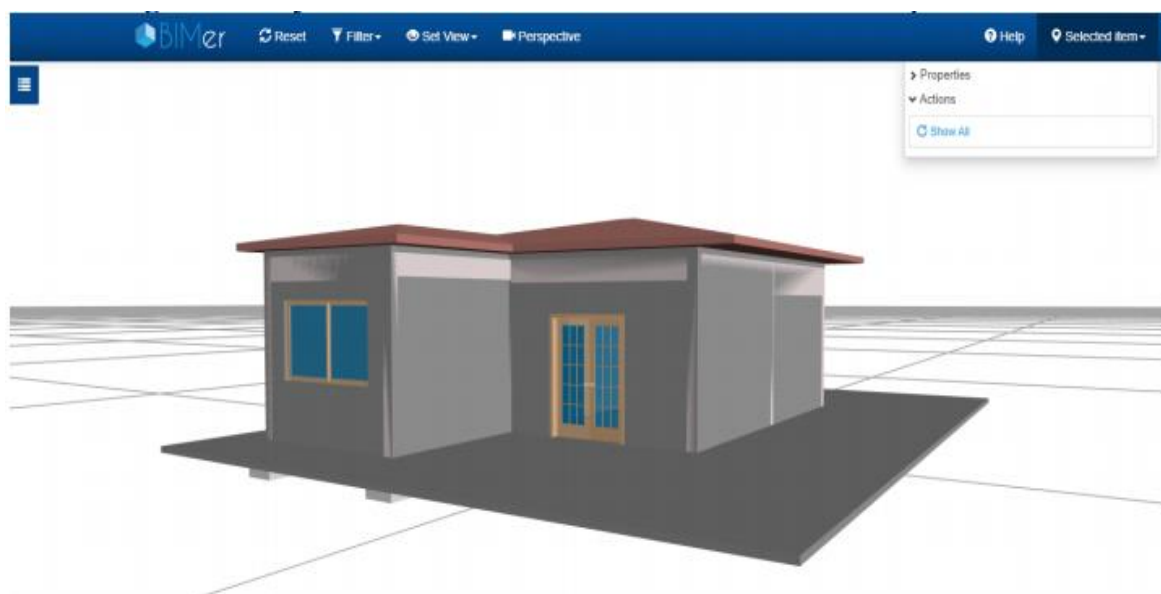
Figura 13 – Projeto sem acabamento. Modelo IFC visualizado pelo software B1Mer.
