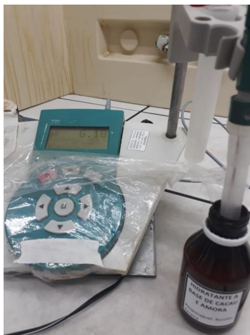
Figura 8 – Medida de pH da amostra manipulada, corrigido com trietanolamina
