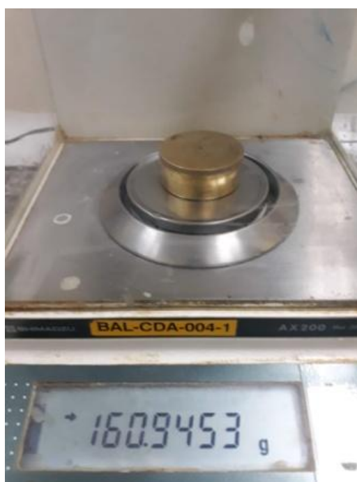
Figura 9 - Pichnômetro mais amostra, na medida de densidade
